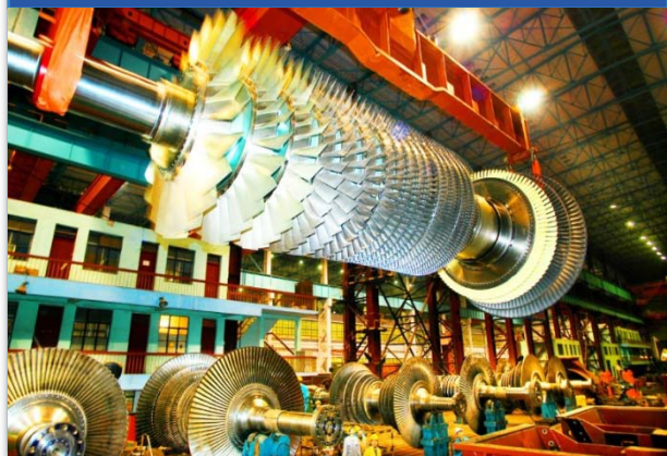
燃机：F级50MW重型燃气轮机整机设计及试验研究有序推进
